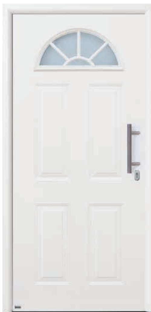
Motiv 200 I Nur NTS Kunststoff-Verglasungsrahmen mit aufliegenden Sprossen Edelstahlgriff 212 2-fach Isolierglas außen VSG klar innen ESG Cathedral kleingehämmert
