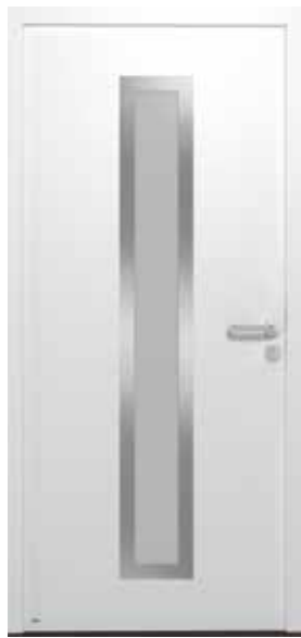
700 A Verkehrsweiß, RAL 9016 Drücker, 3-fach Isolierglas, Außenscheibe VSG klar 6 mm, Zwischenscheibe Float 4 mm vollflächig sandgestrahlt, Innen- seite ESG klar 6 mm
