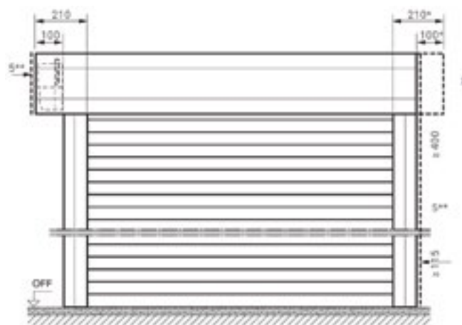
Einbau vor der Öffnung - Außen-Rolltor
