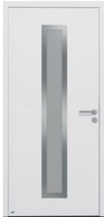
700 A Drücker, 3-fach Isolierglas, Außenscheibe VSG klar 6 mm, Zwischenscheibe Float 4 mm vollflächig sandgestrahlt, Innenseite ESG klar 6 mm
